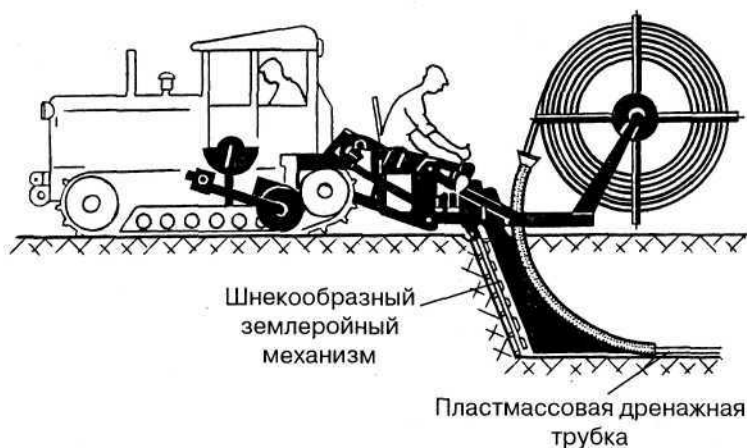
Рис. 12. Укладка пластмассовой дренажной трубы
