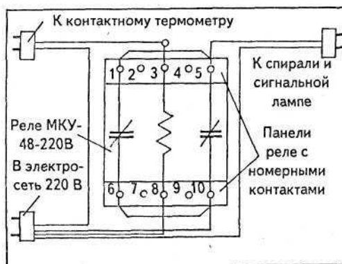
Рис. 92. Электросхема инкубатора
